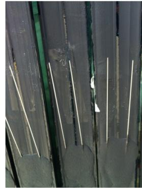
**Die Lagerung von Isolierglaselementen mit Kapillarröhrchen darf nur in Räumen mit niedriger Luftfeuchtigkeit erfolgen. Selbst eine kurzzeitige Lagerung im Freien bzw. in feuchten Räumen ist zu vermeiden!**
