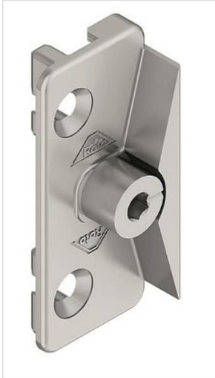
Durch das Drehen der exzentrischen Stellschraube am Rahmenteil der Niveauschaltsperrre kann der Flügeleinlauf um bis zu 0,8 mm angehoben bzw. abgesenkt werden.
